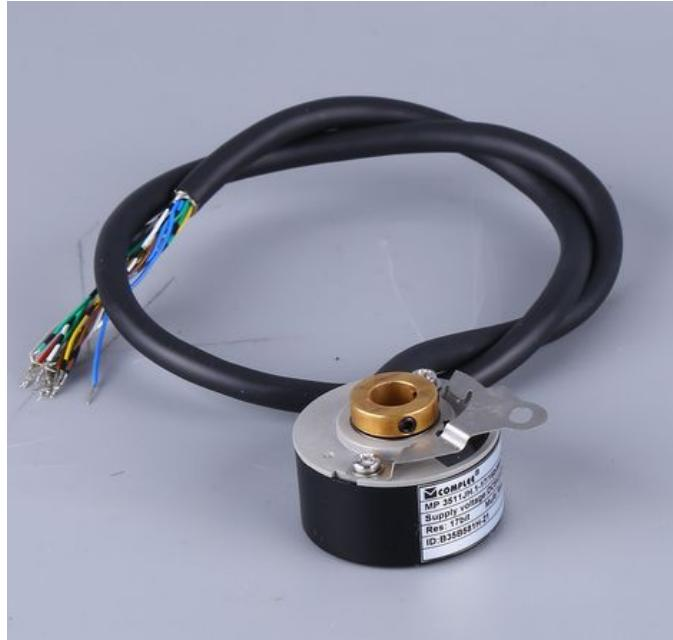
磁电编码器安装注意事项主要有以下几点：一、装置时不要给轴施加直接的冲击。编码器轴与机器的衔接，应运用柔性衔接器。在轴上装衔接器时，不要硬压入。即便运用衔接器，因装置不良，也有可能给轴加上比答应负荷还大的负荷，或形成拨芯表象，因而，要格外注意。轴承寿数与运用条件有关，受轴承荷重的影响格外大。如轴承负荷比规则荷重小，可延伸轴承寿数。二、振荡。加在旋转编码器上的振荡，往往会变成误脉冲发作的缘由。因而，应对设置场所、装置场所加以注意。每转发作的脉冲数越多，旋转槽圆盘的槽孔间隔越窄，越易遭到振荡的影响。在低速旋转或中止时，加在轴或本体上的振荡使旋转槽圆盘颤动，可能会发作误脉冲。磁电编码器配线和衔接也要特别注意，磁电编码器误配线，可能会损坏内部回路。
